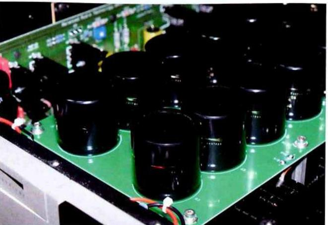
●電源供應的容量驚人，使用了自家等級最高、音質最細膩的SUPER-PAK油浸電濾波電容。中央兩排電容的下方，藏著兩顆巨大的電源變壓器，分別供應左右聲道使用。
